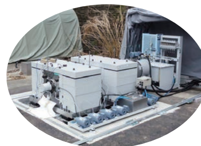
最新設計によるACROSS電源装置 基礎や電源のローコスト化が図られている。
