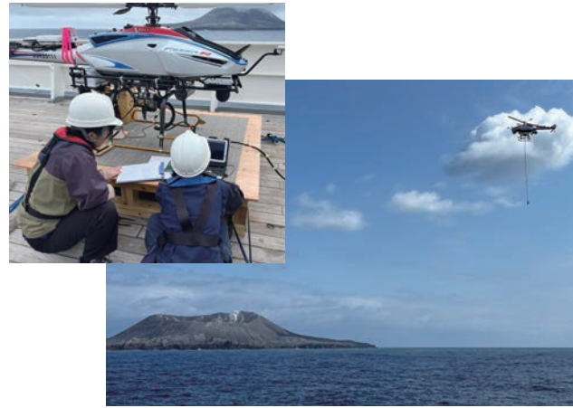
西之島火山における空中磁気観測の様子 (右下) 観測に向かう無人ヘリ (左上) 船上での機材整備の様子
